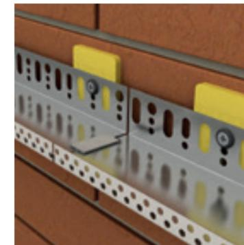
El set de montaje se utiliza para la fijación del perfil de arranque, de esquina, lateral y de coronación con tornillos cincados o de acero inoxidable y tacos adecuados al soporte, a una distancia entre tornillos no superior a 30 cm y en los encuentros o vértices, no inferior a 15 cm. Los perfiles deben separarse entre sí unos 2 o 3 mm mediante los conectores para evitar los contactos en las dilataciones. Para nivelar soportes irregulares, utilizaremos los distanciadores.
