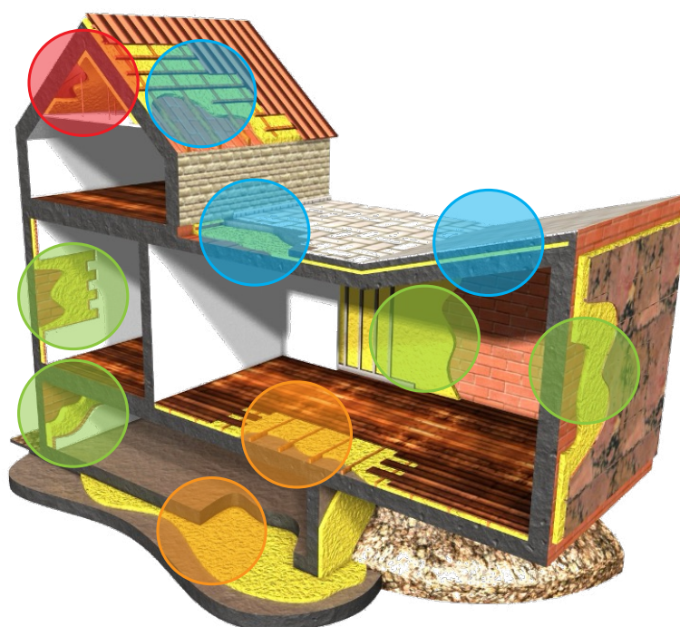
Actuaciones de aislamiento térmico posibles en un edificio
