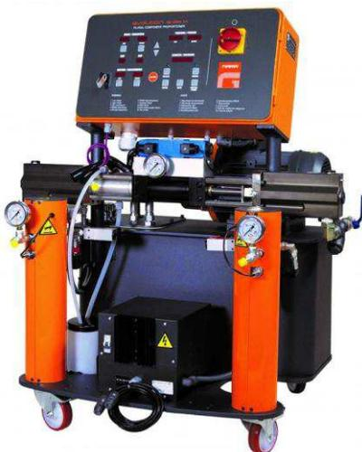
El nuevo equipo **evolution G-35H**, de accionamiento hidráulico, ha sido diseñado y construido para dar respuesta a los requerimientos más exigentes en aplicaciones industriales y aplicaciones in situ de sistemas bicomponentes complejos que deben ser procesados con gran precisión en la dosificación para garantizar la máxima calidad de la mezcla de los componentes químicos.
